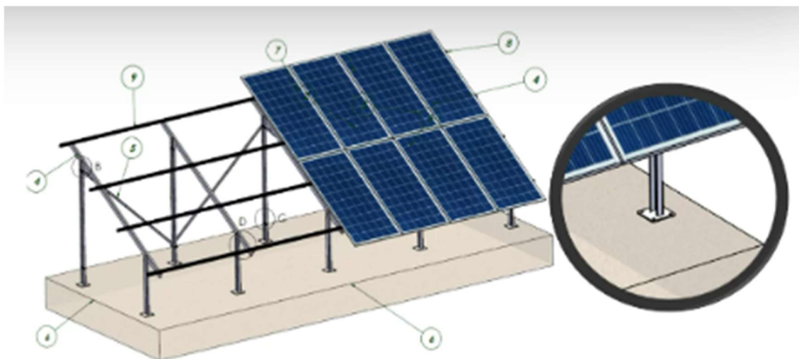
Figura 11 – Structura fotovoltaică montată pe sol, Cu placă de prindere din beton, pe două rânduri așezate portret
